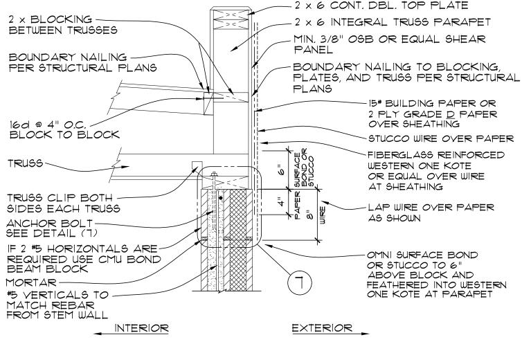
NOTE: FLUSH SHEATHING FACE WITH BLOCK FACE AT JUNCTION FOR PROPER STUCCO FINISH
